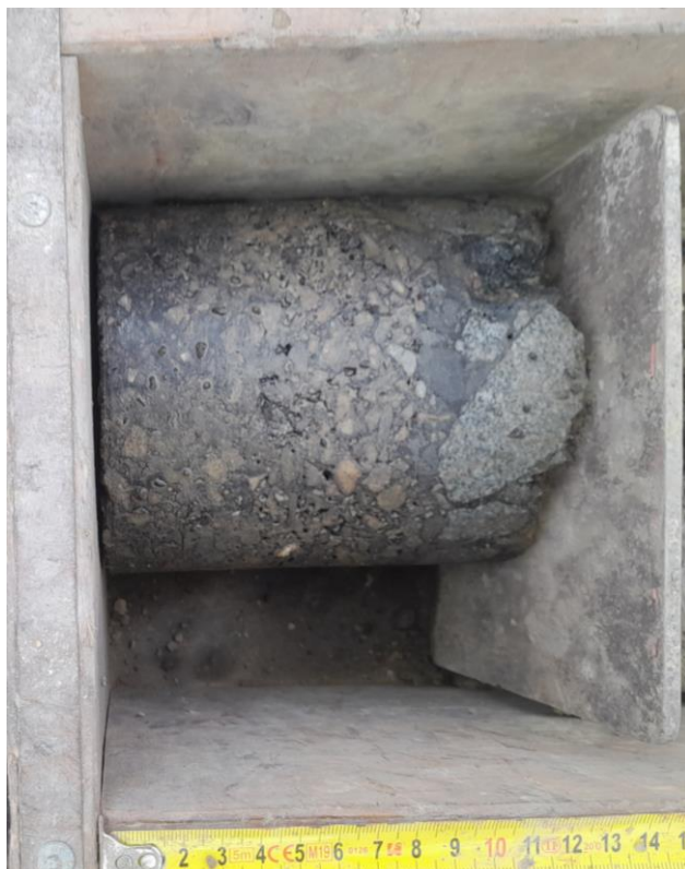
Detail asfaltových vrstev HS 4-1 a vrstvy penetračního makadamu HS 4-2
