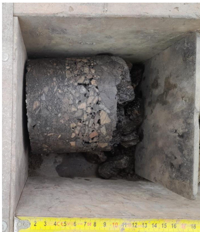
Detail asfaltových vrstev HS 3-1 a vrstvy penetračního makadamu HS 3-2
