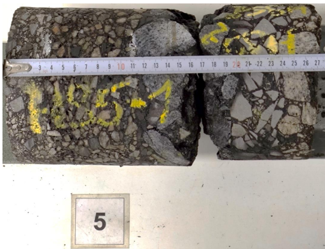
Vývrt JV 5 hloubkové sondy HS 5
