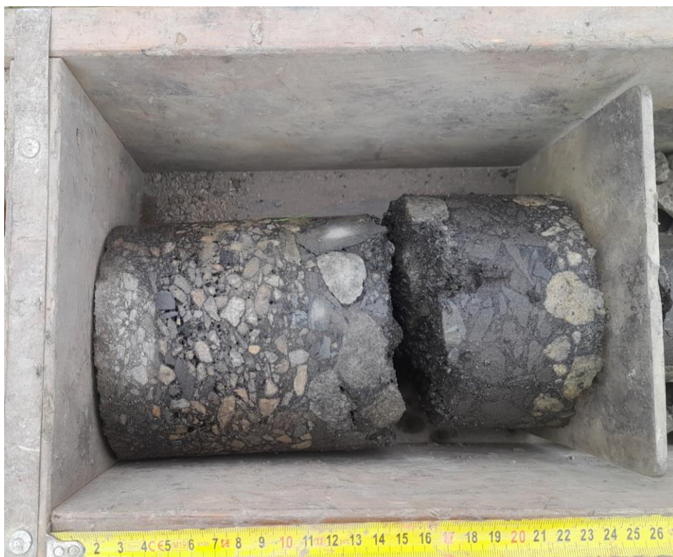
Detail asfaltových vrstev HS 5-1 a vrstvy penetračního HS 5-2
