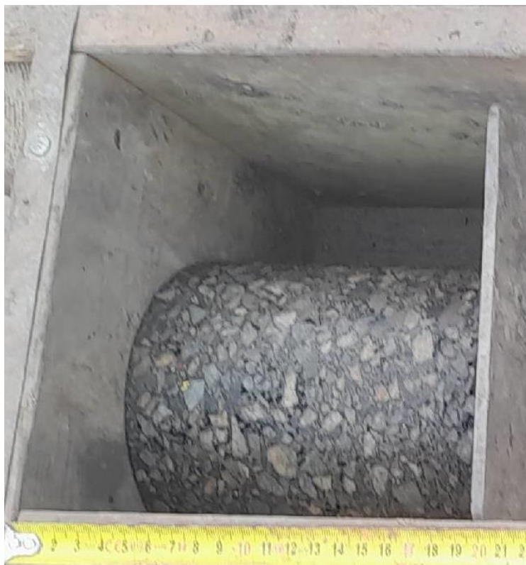
Detail asfaltových vrstev HS 1-1
