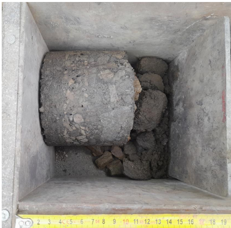
Detail asfaltových vrstev HS 2-1 a vrstvy penetračního makadamu HS 2-2
