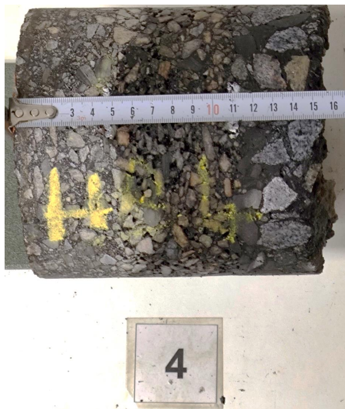
Vývrt JV 4 hloubkové sondy HS 4
